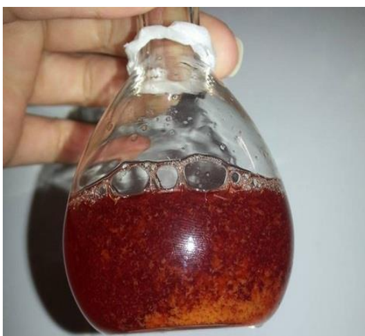
Figura 6. Destaque para a solução 1 do TESTE 3 - formação de precipitado com a adição da enzima (acervo das pesquisadoras).
