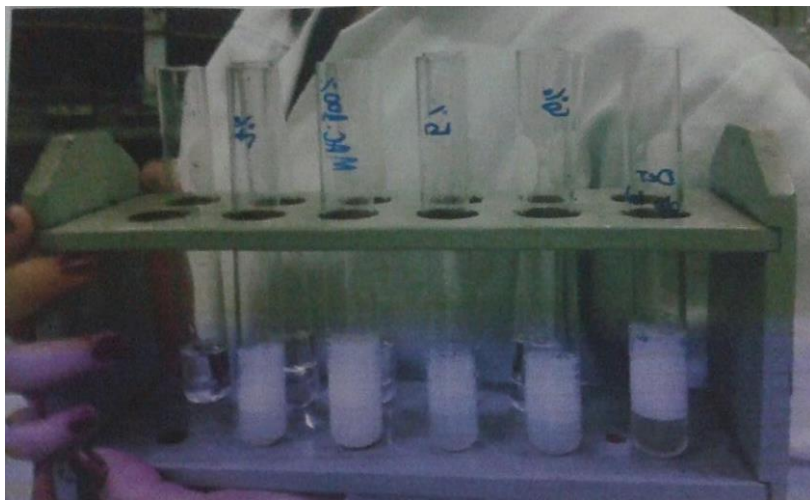
Figura 11 - Testes com óleo de soja comercial e água em diferentes concentrações (autoria do grupo)
