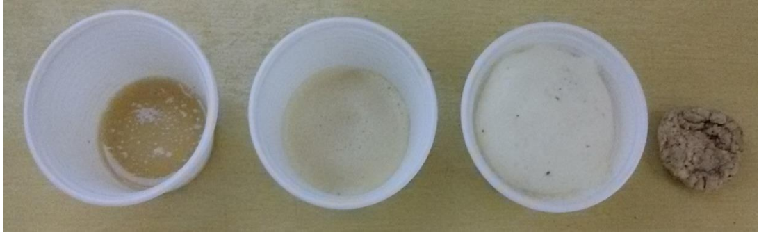
Figura 1 – Da esquerda para direita: não ocorreu formação de espuma; espuma dura; espuma macia; espuma biodegradada (autoria do grupo)
