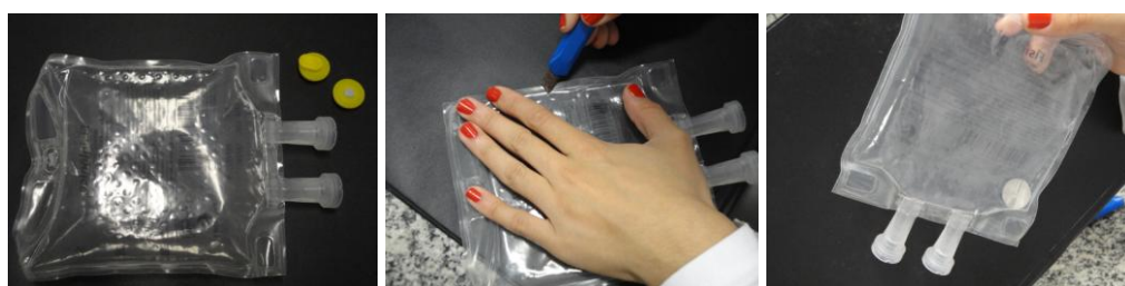
Figura 8. Corte na bolsa para inserção do disco metálico.
