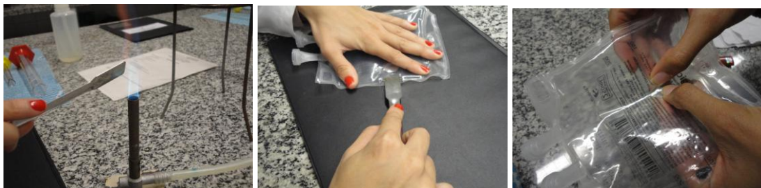
Figura 9. Fechamento da bolsa por aquecimento.
